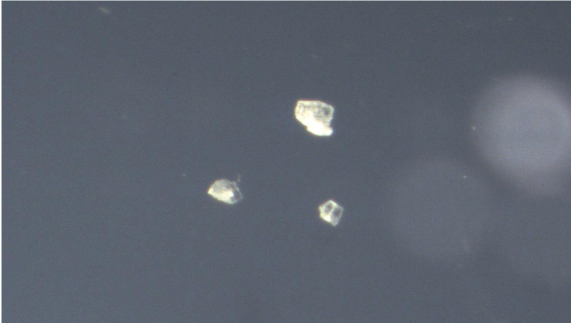
Figura A6 – Fotografia retirada ao microscópio dos cristais de AP obtidos através de sublimação por dedo frio
